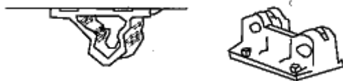
図3-1-1 計算による強度確認を行う必要のない緊締金具及びすみ金具
