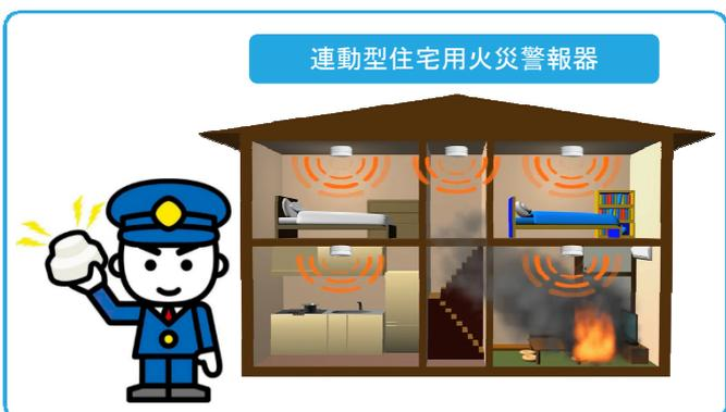
※交換の際は連動型住宅用火災警報器などの付加的な機能を併せ持つ機器へ交換しましょう。
