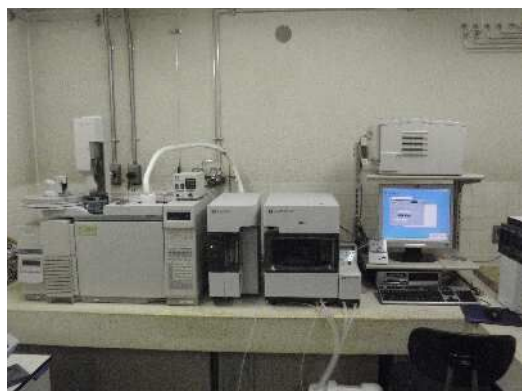
パージ&トラップ装置付ガスクロマトグラフ質量分析計 (トリハロメタン等の測定)
