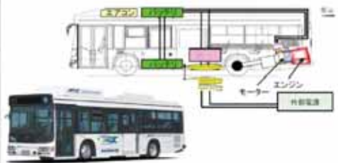
IPS(非接触給電方式) ハイブリッドバス 資料：国土交通省
