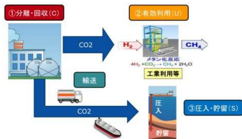
図 1-19 CCUS 技術の概要
