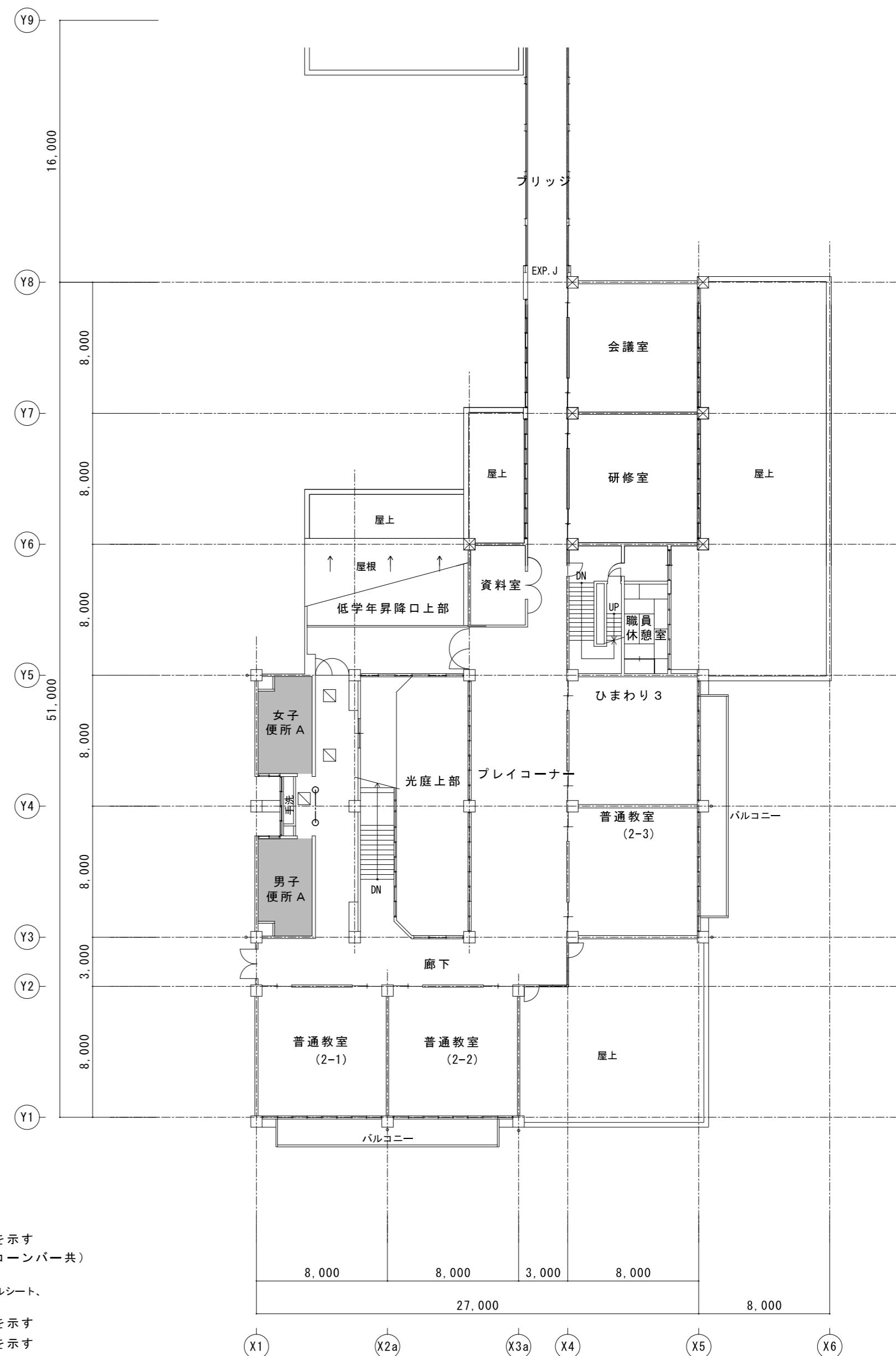
2階全体平面図兼仮設計計画図 現況
