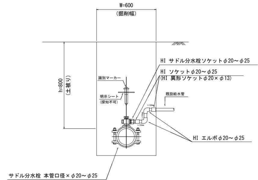
仮設給水管接続標準図
