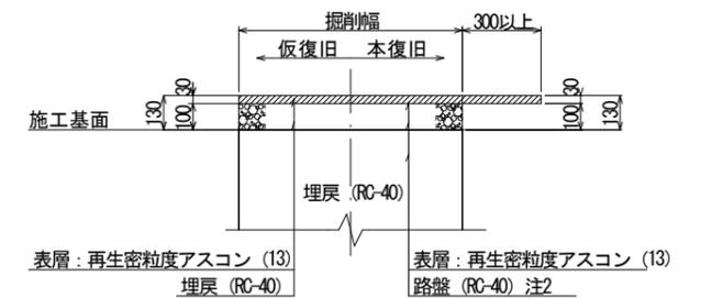
注1) 路線B(二次施工)の水道工事については、路盤下からの掘削、路盤下までの埋戻しとする。
