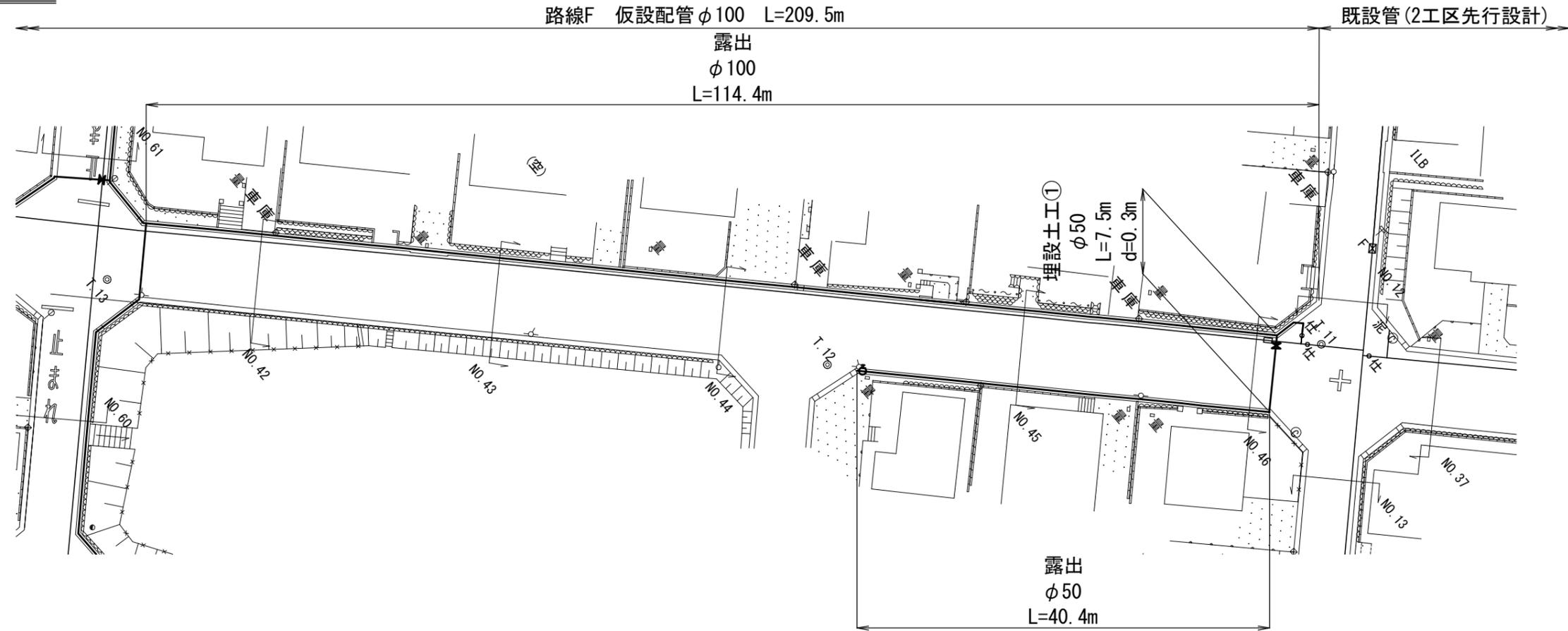
仮設配管詳細図-10 S=NO SCALE
