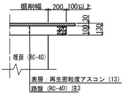
注1) 仮復旧時の埋戻 (RC-40) をもって下層路盤 (RC-40) と見なす。
