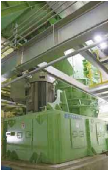
■高速回転式破砕機 高速回転式破砕機で、たたき・砕き・切断してさらに細かくします。
