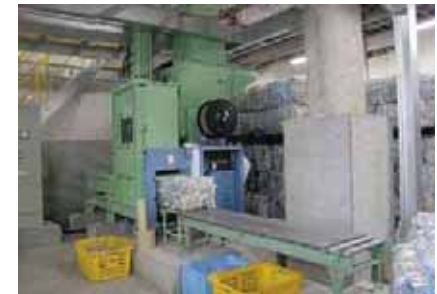
■ペットボトル圧縮梱包機 回収されたペットボトルを圧縮し梱包します。
