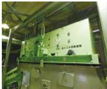
■低速回転式破砕機 ゆっくりと回転する刃でごみを大まかに破砕し、その後の処理をスムーズにします。
