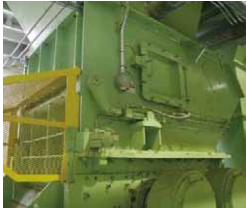
■低速回転式破砕機 ゆっくりと回転する刃でごみを大まかに破砕し、その後の処理をスムーズにします。
