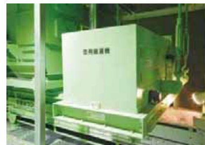
■缶用磁選機 電磁石を使って缶の中からスチール缶を選別します。
