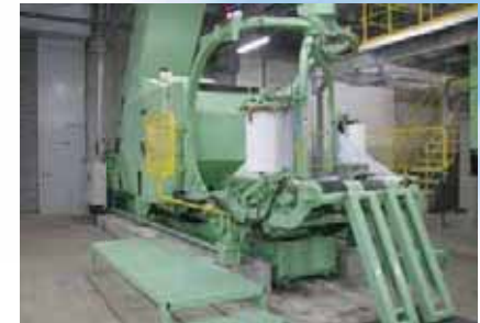
■プラスチック製容器包装圧縮梱包機 回収されたプラスチック製容器包装を圧縮し梱包します。
