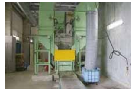
■缶用圧縮機 回収されたスチール缶やアルミ缶を圧縮します。
