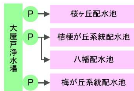
図3 大屋戸浄水場系統フロー
